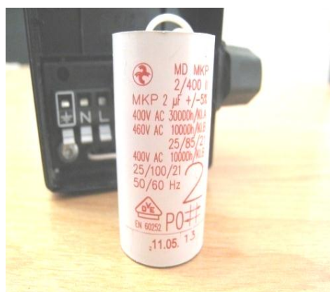
خازن پمپ سیرکولاسیون
